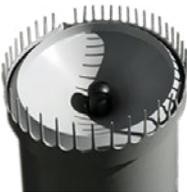
**Vogelschutzgitter:** Das Vogelschutzgitter hält Wildvögel davon ab, sich auf das Gerät zu setzen oder dort zu rasten. Es erhöht somit die Genauigkeit, weil weniger Vogelkot in den Trichter des Messgeräts fällt.
