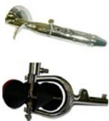
becherartiges Gerät mit modernem Kontaktschaltssystem. Es ermöglicht präzise und wiederholbare Abflussmessungen in Bächen, Kanälen, Druckleitungen, Seen und Meeren.
