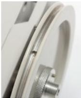
**Schwimmerscheibe und Schnur:** Die Schwimmerscheibe kann sowohl mit einer Perlschnur als auch mit einer Schnur ohne Perlen eingesetzt werden. Passgenaue
